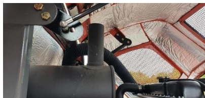
Motorhuv, mycket välisolerad samt med gasdämpare
