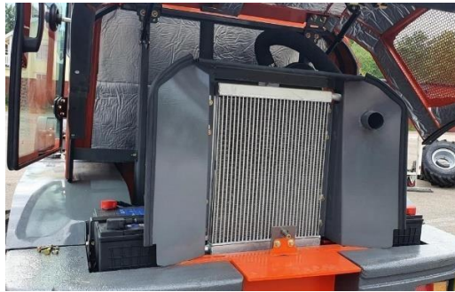
Motor-utrymmet med batterier lätt åtkomligt samt skyddsplåtar till motor
