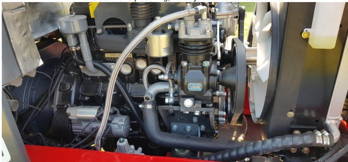
Kompressor till tryckluftbroms
