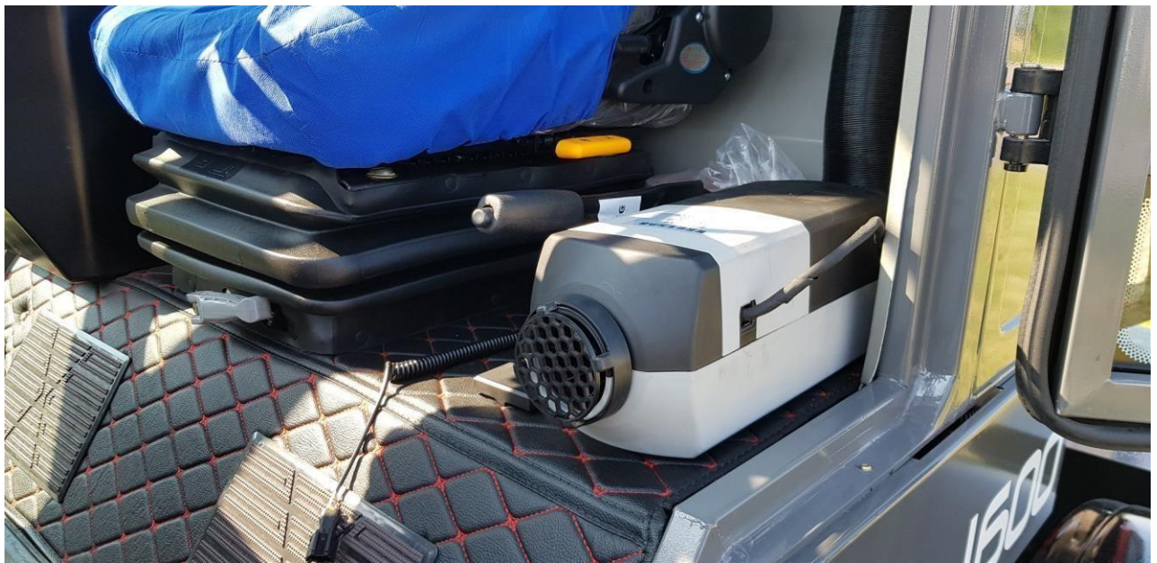
HZM-RRUN 1600 är utrustad med dieselvärmare på 5 Kw som ger en behaglig värme i hytten.
