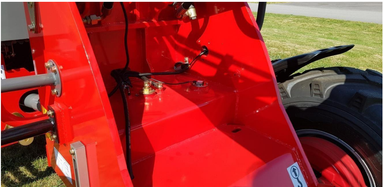
Bränsletankens placering, väl skyddad mellan lastararmarna
