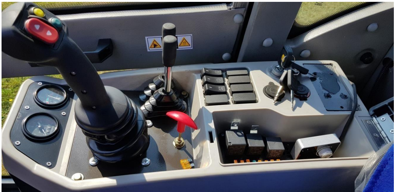
Elektrisk joystick med fram och bak samt 3e & 4e funktion
