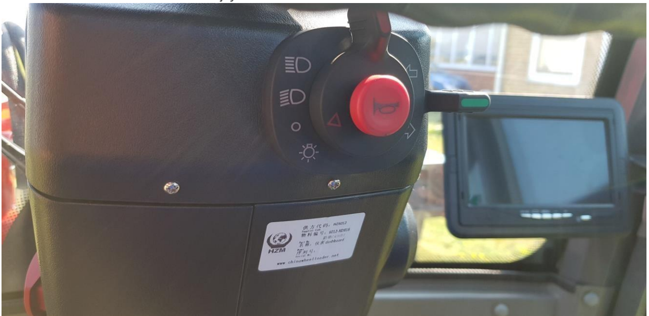
Hel och halvljus, tuta samt blinkers reglage
