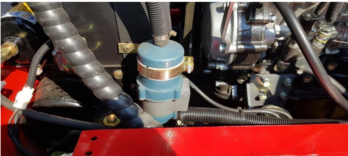
Kraftfull motorvärmare på 2kW
