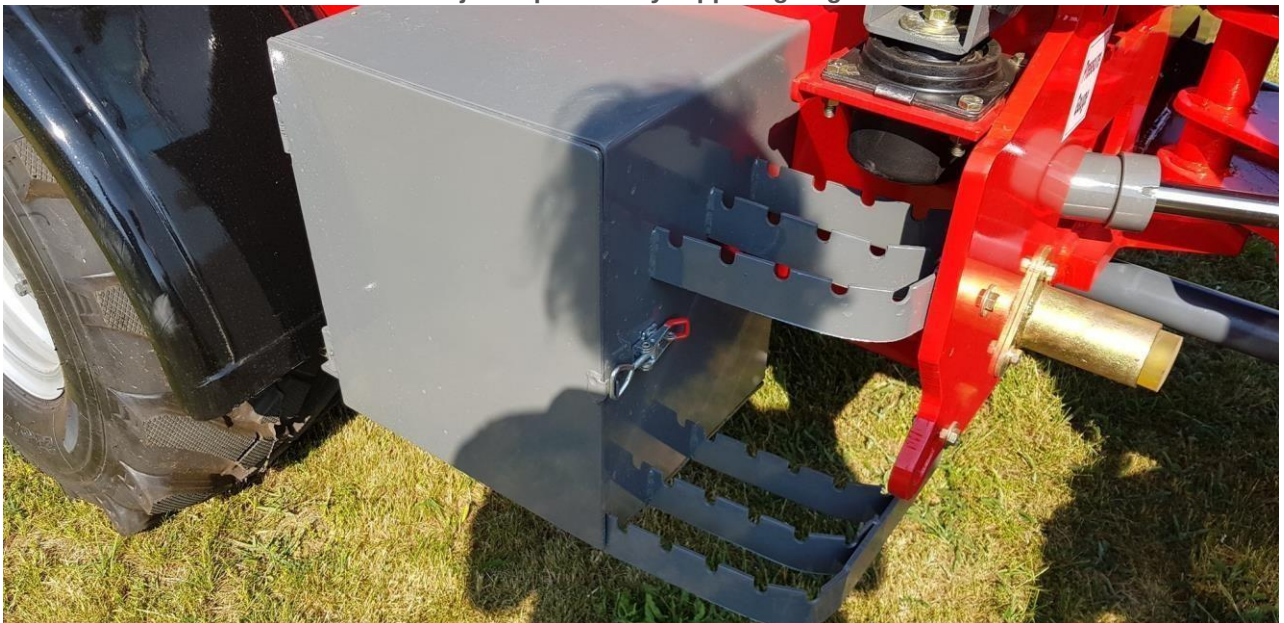
Batteriboxen lätt åtkomligt samt urethangummidämpare i midjan
