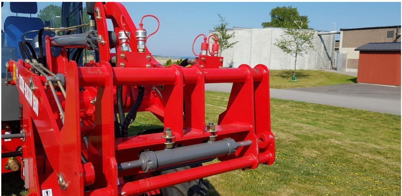
HZM-RRUN1600 är utrustad med Trima Quickhitch redskapsfäste, vilket gör att du inte behöver kliva ur maskinen när du byter redskap. Stor fördel är att du även kan använda dina befintliga redskap
