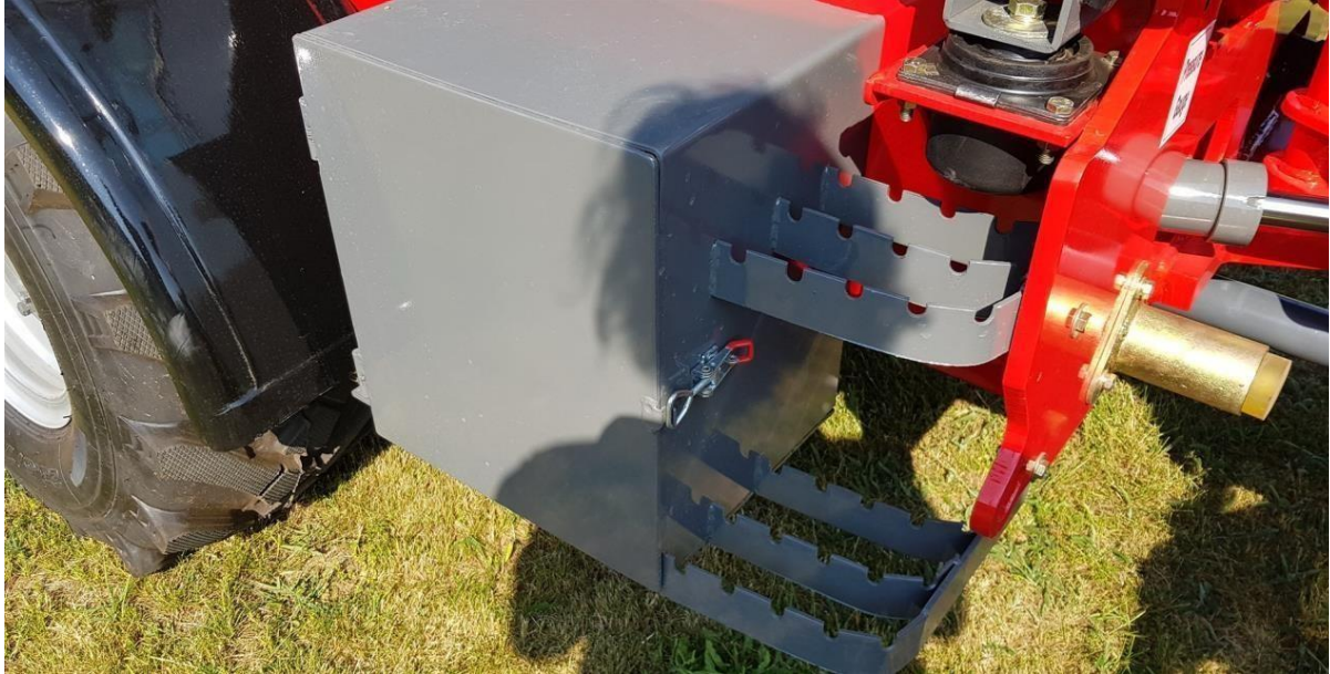
Batteriboxen lätt åtkomligt samt urethangummidämpare i midjan
