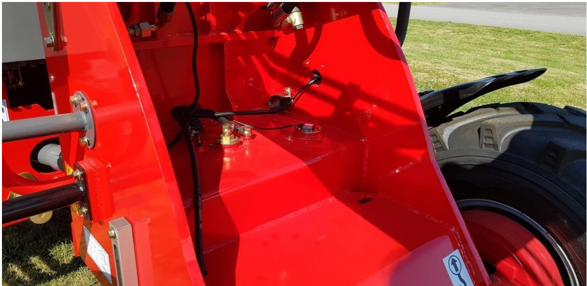
Bränsletankens placering, väl skyddad mellan lastarmarna
