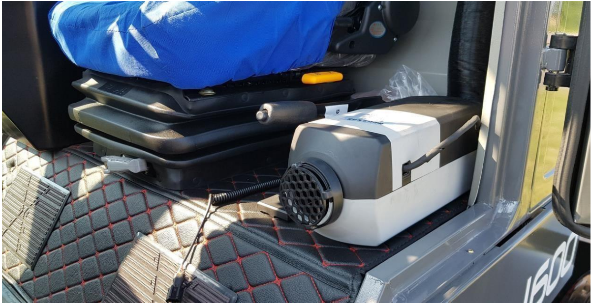
HZM-RRUN 1600 är utrustad med dieselvärmare på 5 Kw som ger en behaglig värme i hytten
